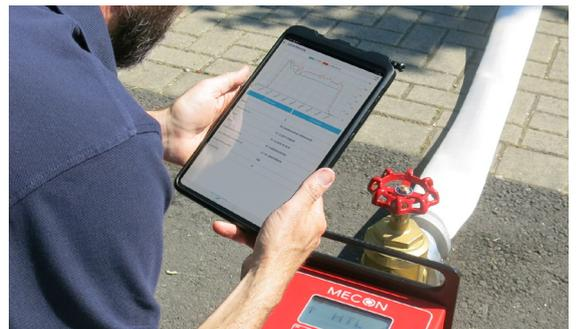
Der Messvorgang kann, neben dem gut ablesbaren Display, auch über die praxiserprobte App der Firma wasserkarte.info gesteuert werden. Alle Messdaten für Druck, Durchfluss, Temperatur und Trübung werden live vom Hydrantentestgerät in die App übertragen. Die Messprotokolle sowie Diagramme werden direkt als Vorschau angezeigt. **Der ganzheitliche Lösungsansatz für die Hydrantenwartung von der Dokumentation, Planung, Lokalisierung, Leistungsfähigkeit bis hin zur Instandhaltung.**
